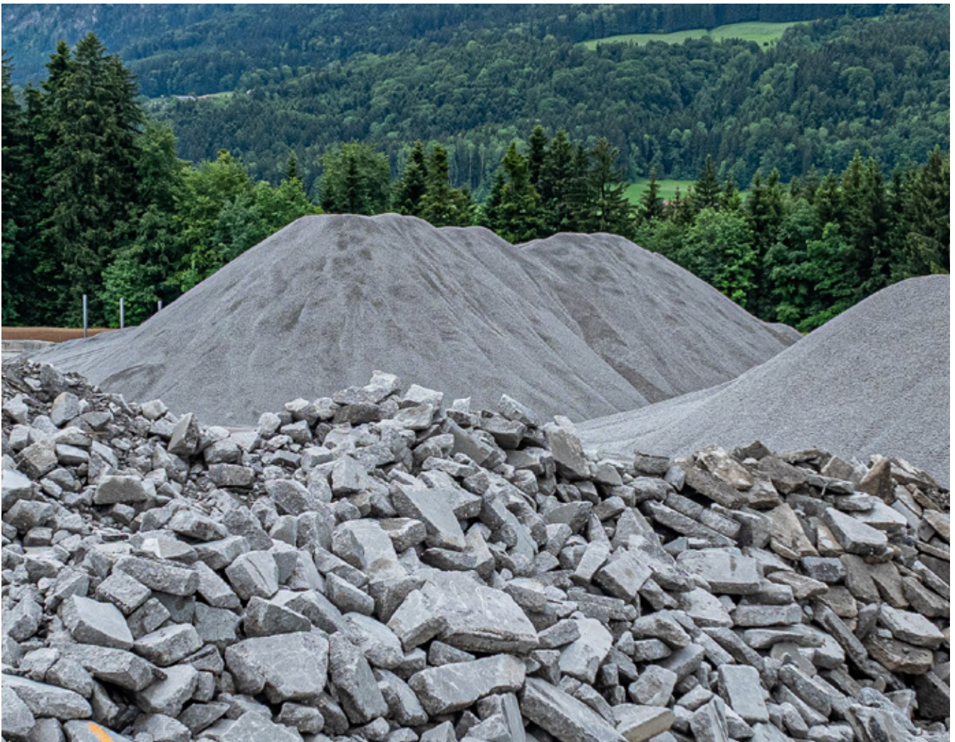
A1 Schmittenhäusl, Betonrecycling: die alte Betondecke wird nicht entsorgt, sondern im Rahmen des Projekts direkt wiederverwendet.
